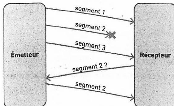
Exemple de communication avec le protocole TCP/IP. La fiabilité de transmission est assurée.
