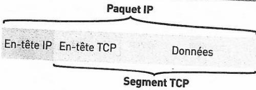
Grâce au protocole IP, les paquets de données transitent de routeur en routeur, depuis la source jusqu'au destinataire.
