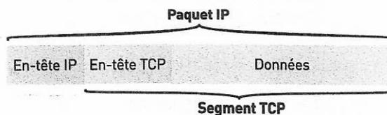
Les données sont « enveloppées » par plusieurs couches de protocoles. Le segment TCP est encapsulé dans le paquet IP. L'en-tête IP contient les adresses IP source et destination.
