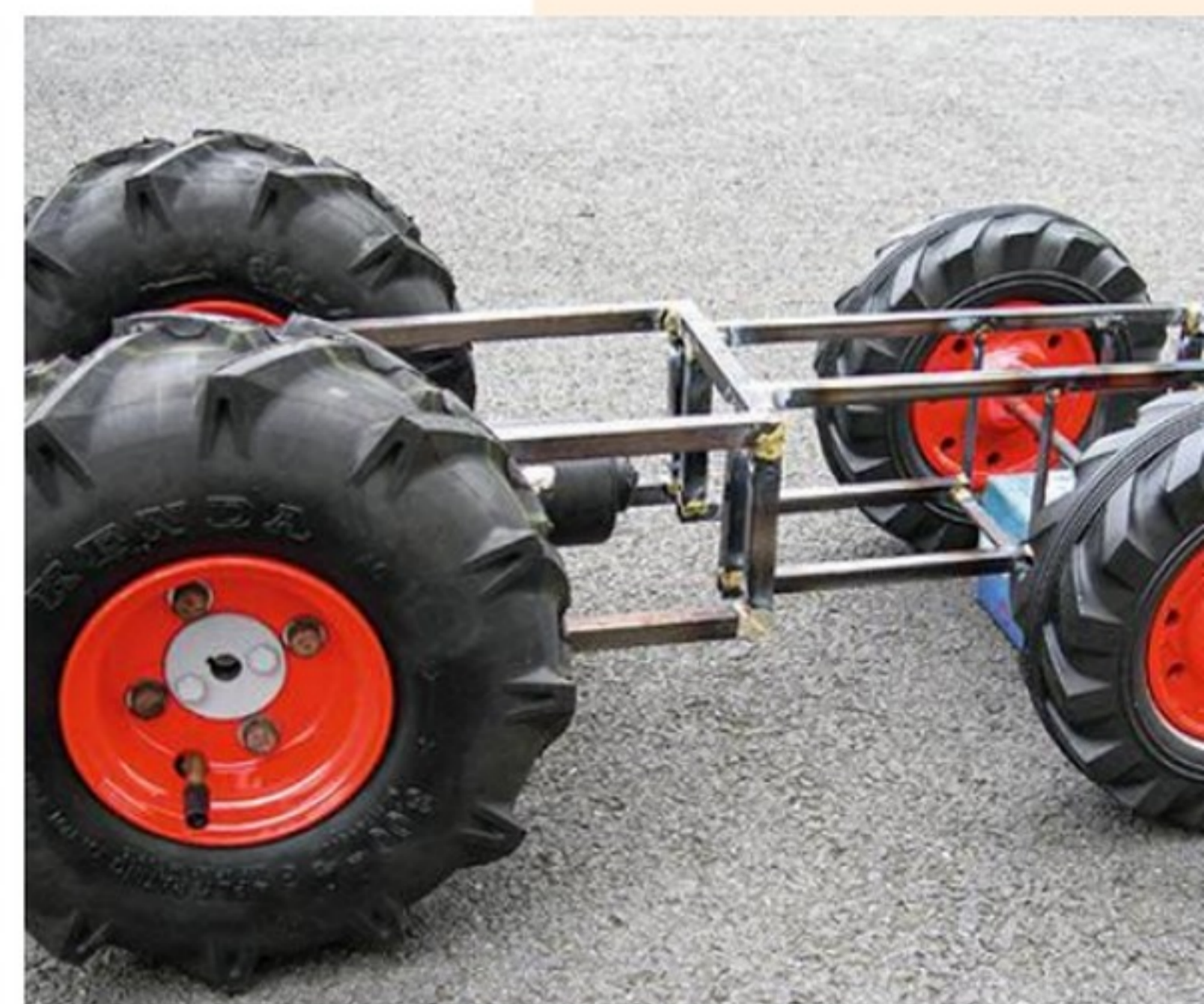
Après complet séchage, les roues sont remises sur leurs jantes puis sur les boulons des essieux. Un essai est effectué pour vérifier leur fonctionnement et la solidité de leur fixation.
