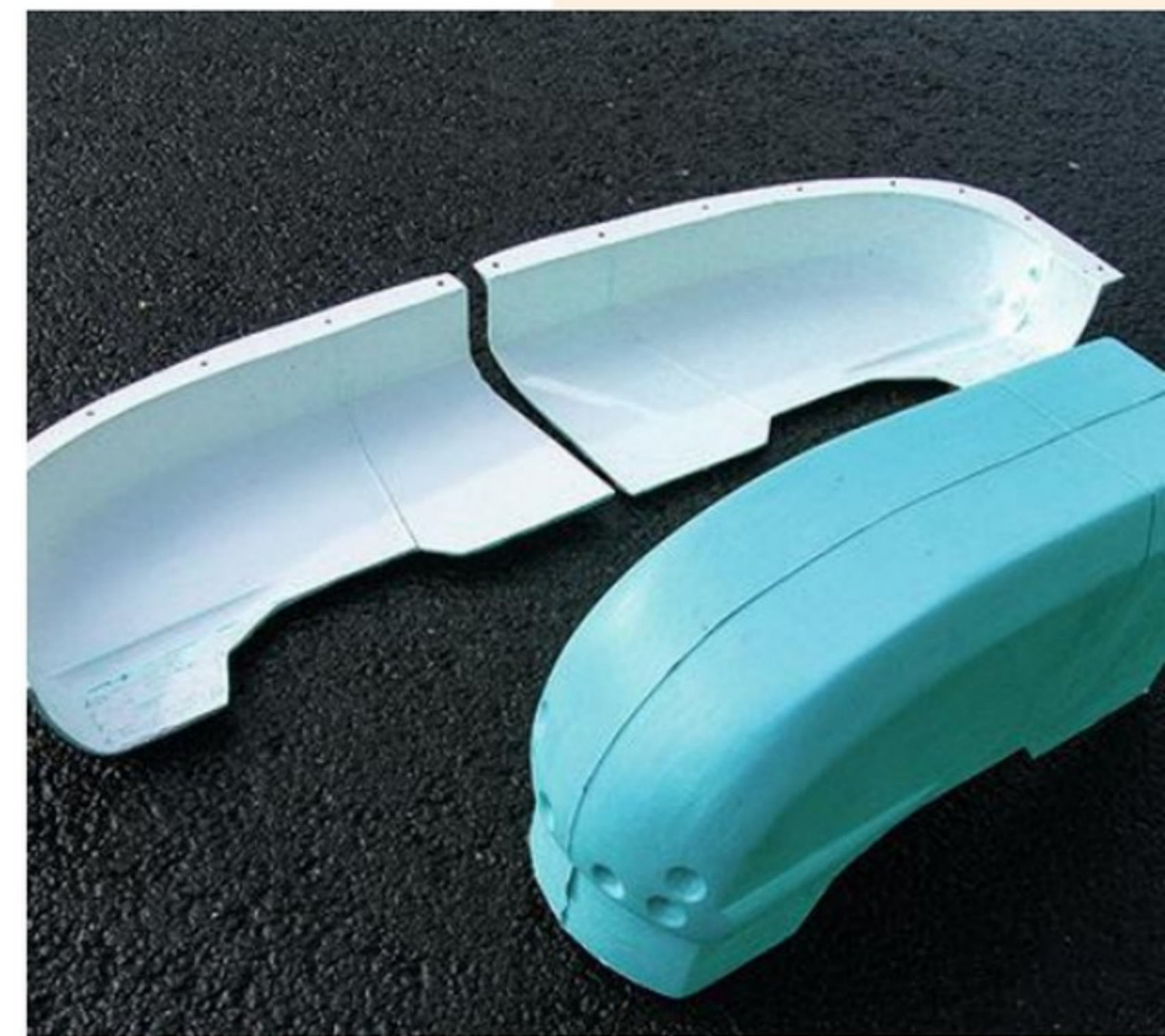
Le capot est en deux éléments. Après démoulage, ils sont nettoyés de leurs éventuelles imperfections et poncés à l'abrasif très fin.
