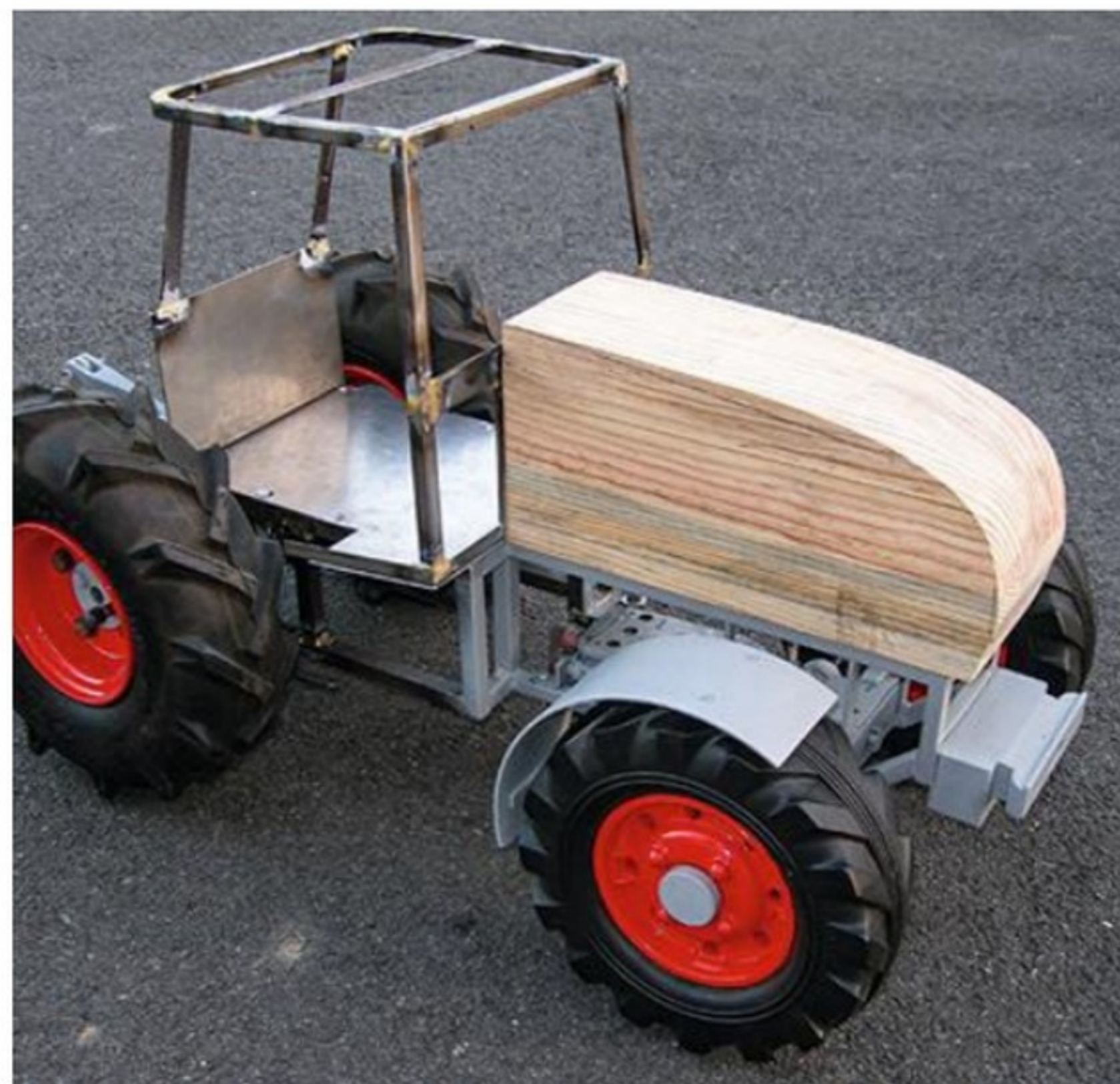
Une matrice en bois est confectionnée pour mouler le capot en résine armée de fibre de verre.
