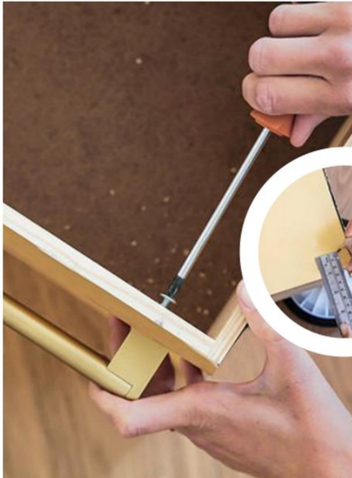
13 Présentez la poignée à son emplacement et marquez ses points de fixation sur la caisse. Après perçage, fixez-la de l'intérieur par deux vis traversantes.
