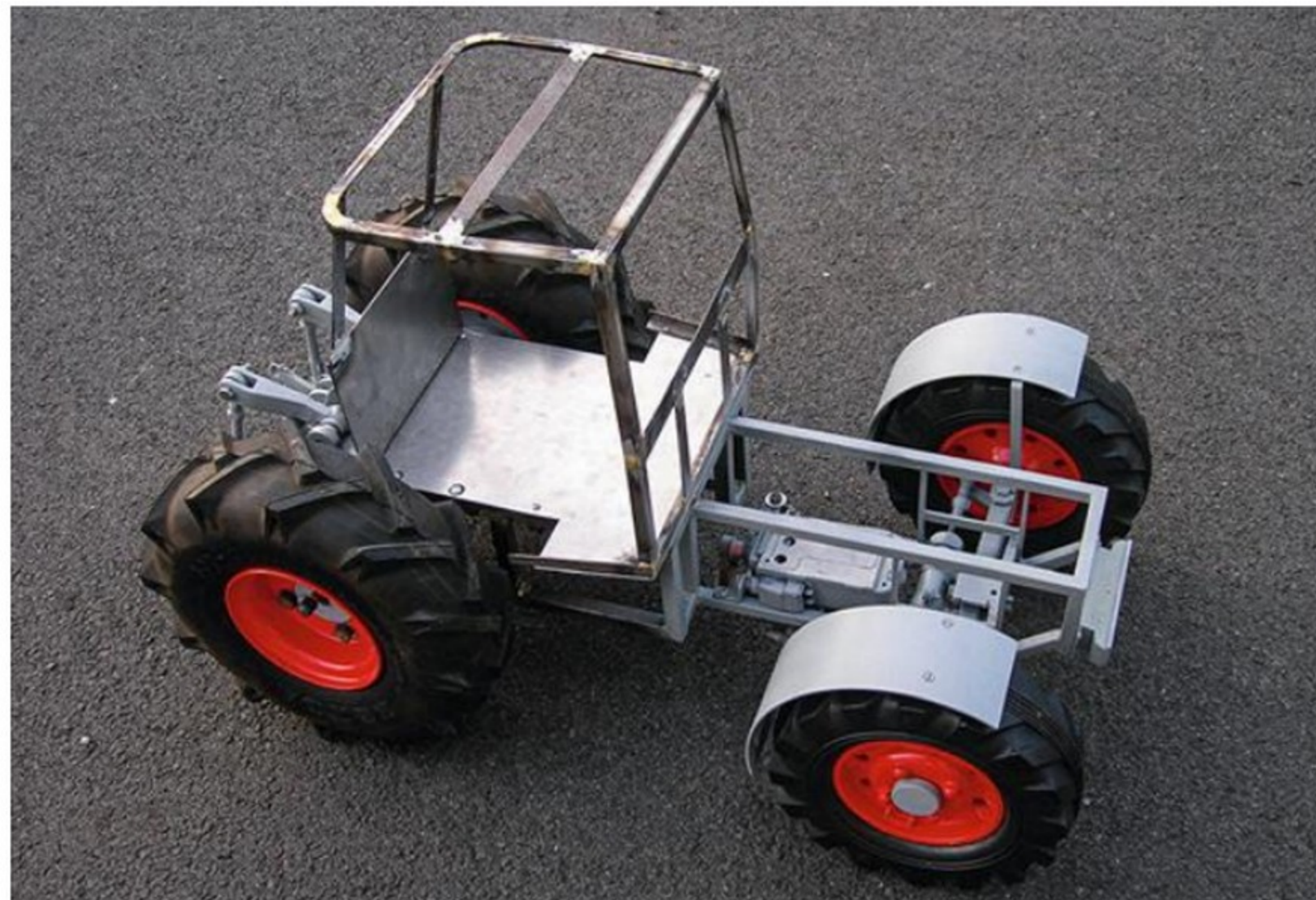
Les garde-boues fixés au châssis, l'ensemble reçoit également une peinture spéciale métal mais de couleur grise. Idem pour le système arrière de levage.
