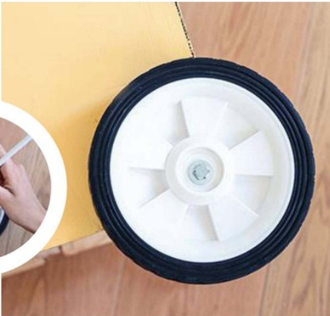
14 Repérez l'emplacement des roues à 25 mm du bas de la caisse et 20 mm de la face arrière. Percez de part et d'autre. Puis montez chaque roue avec une vis à métaux serrée par un écrou et deux rondelles plates intercalées pour conserver leur mobilité.
