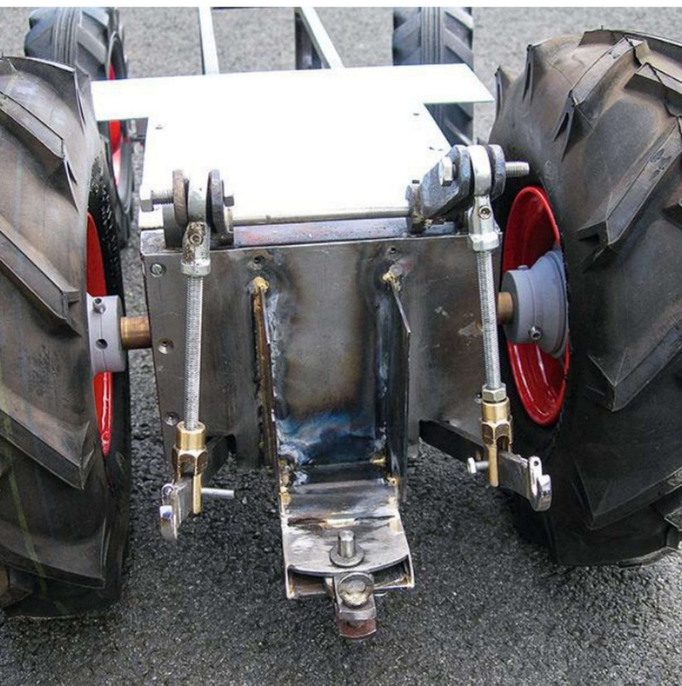
Jean-Claude a poussé le détail jusqu'à créer un système de levage, articulé bien sûr, qu'il a monté à l'arrière du véhicule.
