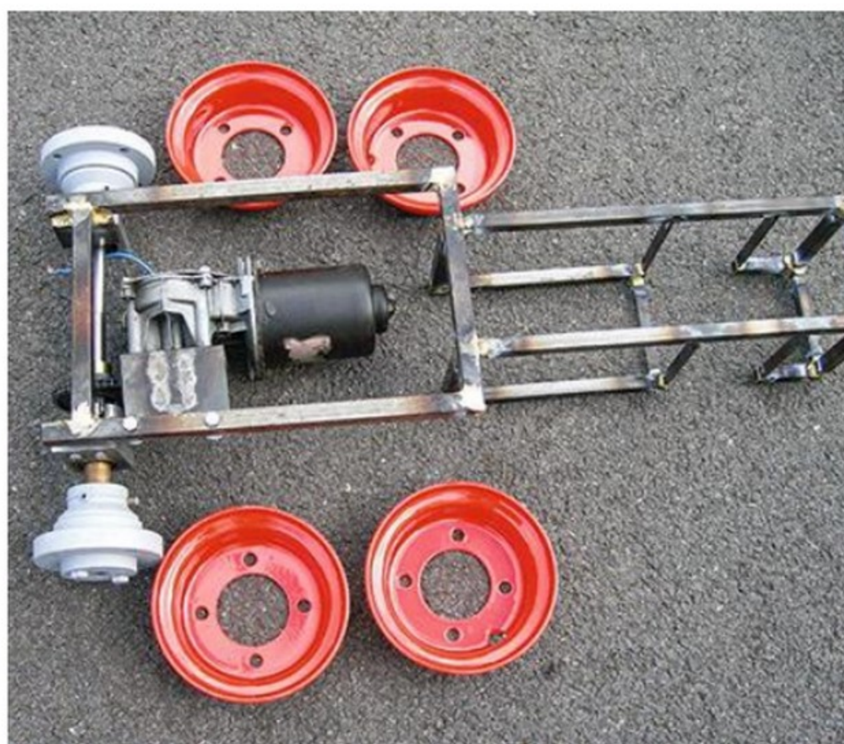
Les jantes avant et arrière ont été démontées afin d'être protégées par une peinture anti-rouille. Au préalable, le métal a été passé à la brosse rotative et dégraissé à l'alcool.
