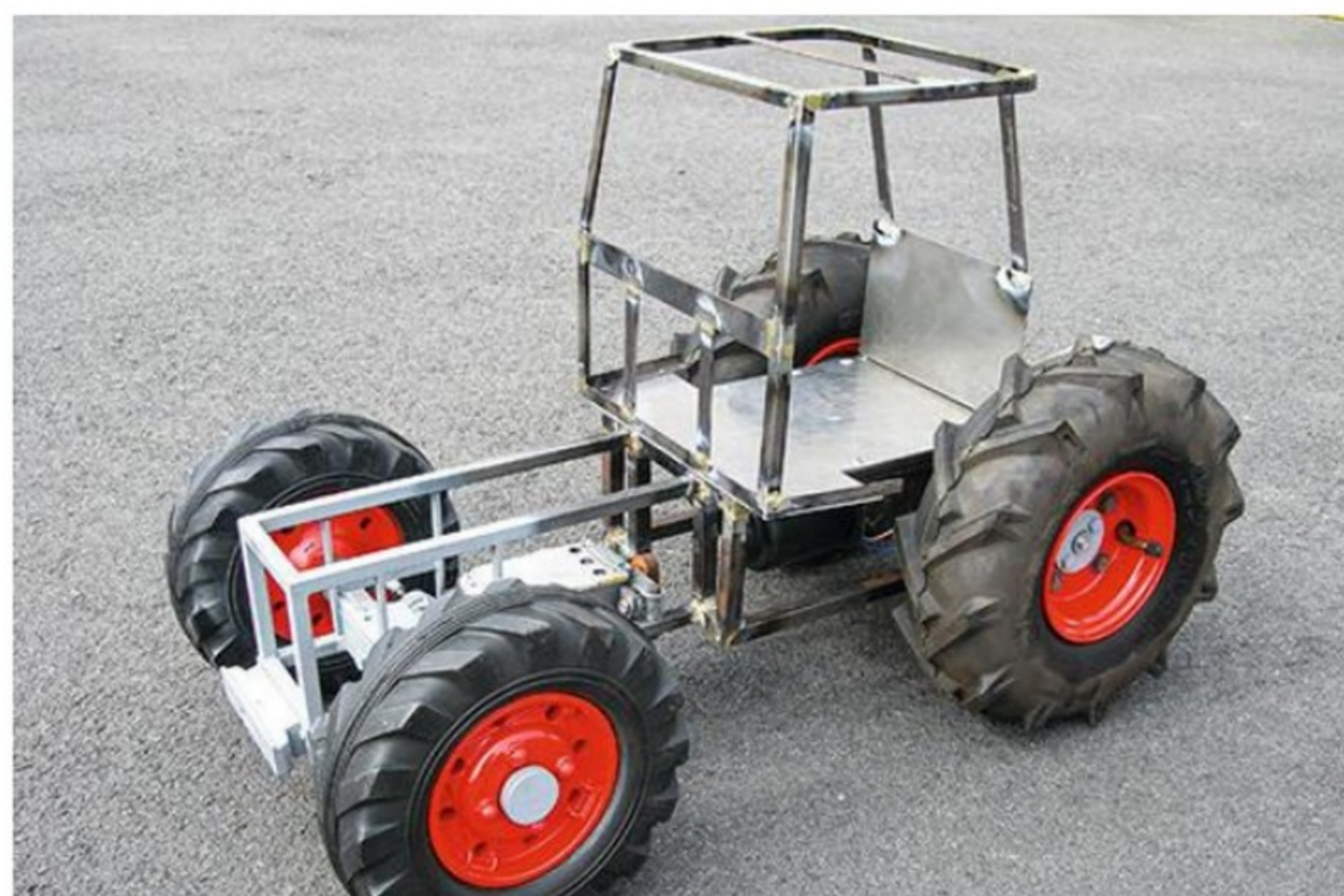
Le châssis de l'habitacle se compose également de tubes soudés. Il est complété d'une tôle pour le plancher et d'une autre à l'emplacement du dossier de l'assise.
