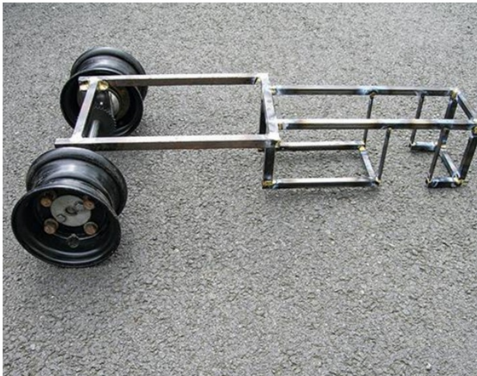
Le châssis est constitué de tubes carrés creux soudés de 12 x 12 mm de section. Il prend place sur l'essieu arrière.
