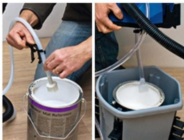
**4/** Pour les gros chantiers, il est préférable d'immerger le tube plongeur directement dans le pot ou de remplir le réservoir de 10 l ou encore d'intégrer le pot (ici 5 l) dans le réservoir de la station.
