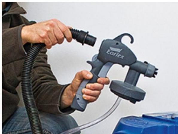
**2/** L'autre extrémité du flexible d'air se met en place à l'arrière du pistolet, de la même façon que le raccordement du tuyau d'air (emboîtement ou raccord baïonnette).
