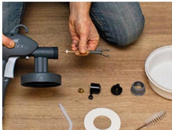
**14/** Pour démonter le pistolet et accéder à la buse-pointeau, **il faut utiliser une clé spécifique** après avoir dévissé l'anneau de serrage du chapeau d'air. Puis ôter la molette de réglage du jet.
