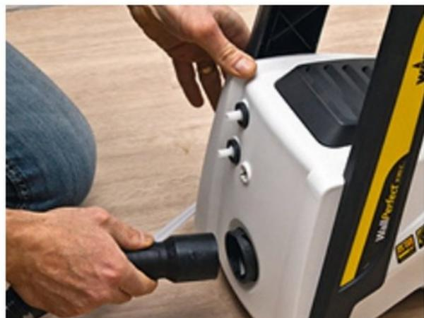
**1/** Le raccordement du tube d'air à la station se fait par simple emboîtement dans l'orifice dédié ou grâce à un mécanisme de baïonnette qui évite tout décrochage intempestif.
