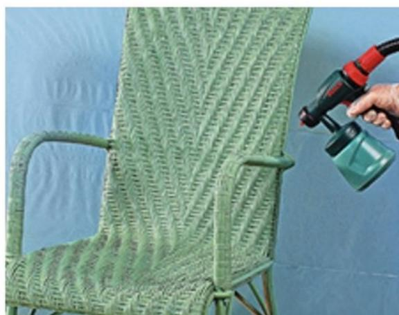
**5/ Sur des supports complexes, le pistolet est très efficace pour déposer un film régulier** jusqu'aux moindres anfractuosités.
