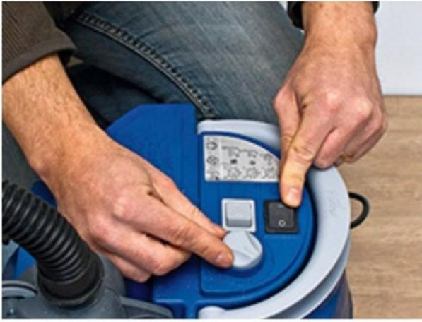
**7/** Le démarrage du moteur s'effectue en **actionnant l'interrupteur situé sur la station**. Selon le mode de fonctionnement, il faut – ou pas – appuyer sur l'interrupteur de la pompe.
