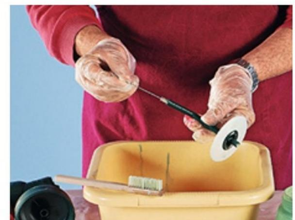
**6/ Le nettoyage du pistolet est essentiel. Remplissez le godet de solvant et pulvérisez le contenu** pour nettoyer le circuit.
