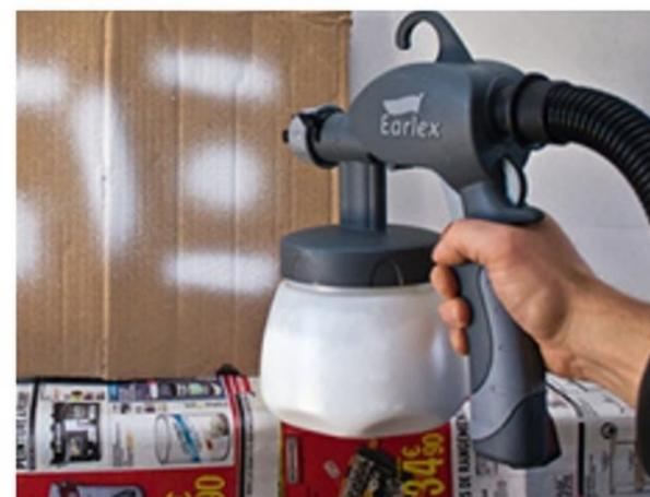
**6/** Un test sur une chute (carton, papier...) permet de vérifier la qualité du rendu et d'ajuster la dilution si besoin, en ajoutant de la peinture ou du diluant.
