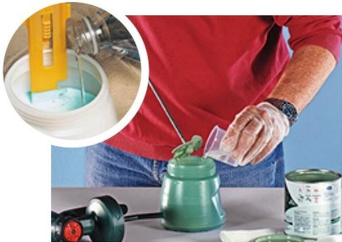
**1/ La plupart des peintures doivent être diluées** pour pouvoir être utilisées avec un pistolet.
