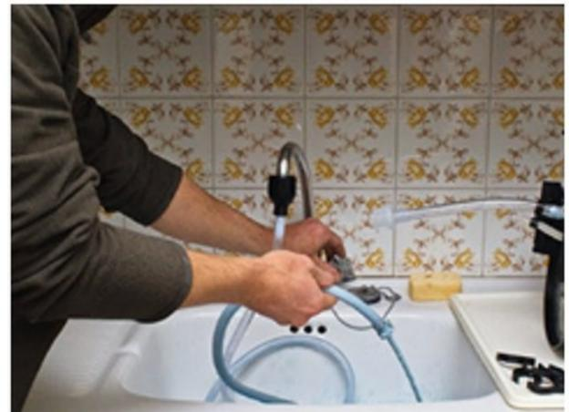
**15/** Pour nettoyer le tuyau de peinture, **la bonne méthode consiste à le raccorder à un robinet** (adaptateur fourni). Le tube plongeur et la cage de filtre se rincent à l'eau, ou avec un diluant approprié.
